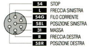
- Schema impianto elettrico per presa e spina
