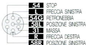
- Schema impianto elettrico per presa e spina
