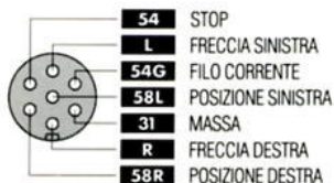
- Schema impianto elettrico per presa e spina
