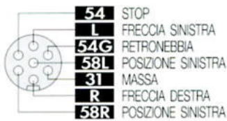
- Schema impianto elettrico per presa e spina
