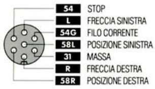
- Schema impianto elettrico per presa e spina
