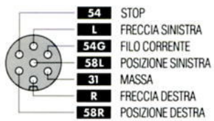
— Schema impianto elettrico per presa e spina
