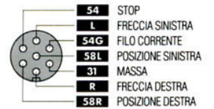
- Schema impianto elettrico per presa e spina
